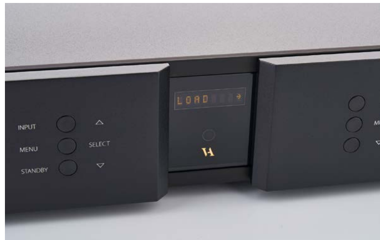
Über diesen Menüpunkt lässt sich die Abschlussimpedanz einstellen
