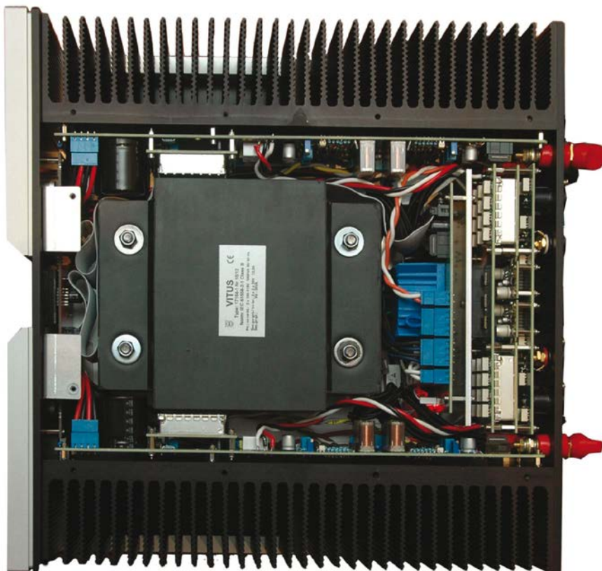
Volle Lotte: Ein speziell entwickelter, massiver UI-Transformator soll einen ungewöhnlich geringen Spannungsabfall bei hoher Belastung gewährleisten (Foto: Vitus Audio)
