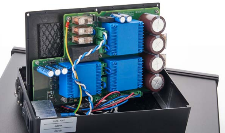
Drei Trafos und einige Kondensatoren zu Filterung befinden sich im separaten Netzteilgehäuse
