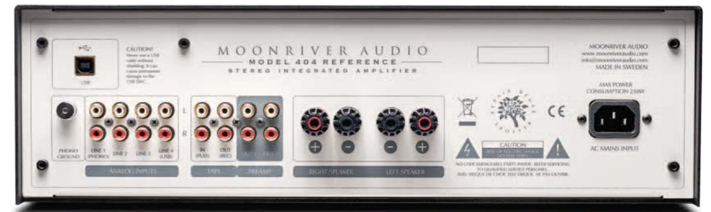
IN VOLLER RÜSTUNG: Die Rückseite bei Vollausrüstung. Die Phonostage sitzt hinter Line 1, die zur Zeit nicht lieferbare USB-DAC-Schnittstelle oben links. Tape Monitor und 2 Pre Outs.
