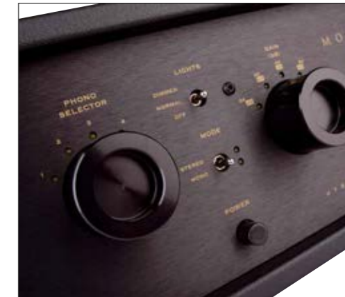
Front links. Hier sieht man vor allem den Eingangsschalter für die vier Eingänge und rechts den Gainregler: alles extrem angenehm in der Praxis
