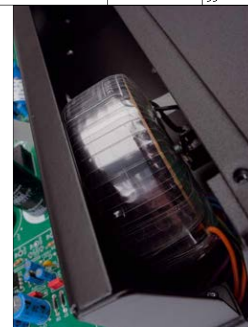
Sauber abgeschirmt sitzt der Ringkern-Netztrafo in seinem eigenen Abteil. Er stellt sechs verschiedene Spannungen zur Verfügung
