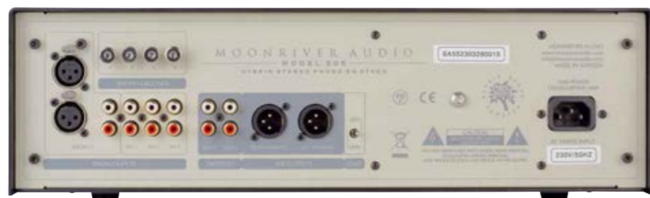
Anschlüsse satt für ganze vier Tonabnehmer inclusive einem XLR Ein- und Ausgang. Viel mehr geht wirklich nicht – außer den vier Erdungsklemmen
