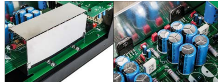
Die empfindlichen Tonabnehmersignale werden unter einer Abschirmung „behandelt“
