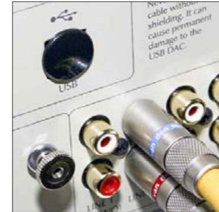
Oben links ist der Platzhalter für die DAC-Platine in Form einer abgedeckten USB-Buchse.
